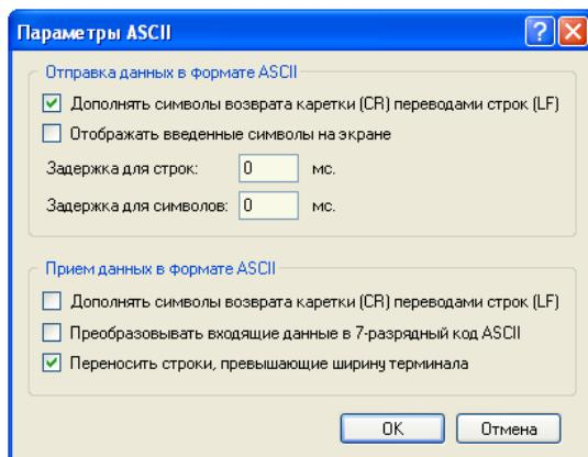
После установки всех параметров, терминал готов к работе.
