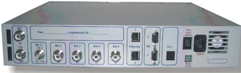
Сзади расположены ВЧ антенные разъемы (типа PL-1, BNC); порты RS232/RS485, 2 RJ-45 (Ethernet), выключатель внутреннего аккумулятора, колодка 220 В, разъем для подключения внешнего аккумулятора. Не используемые отверстия закрыты заглушками.
